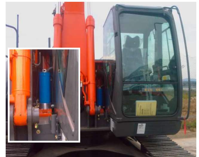
Koparka wyposażona w filtr boczny FN 060
