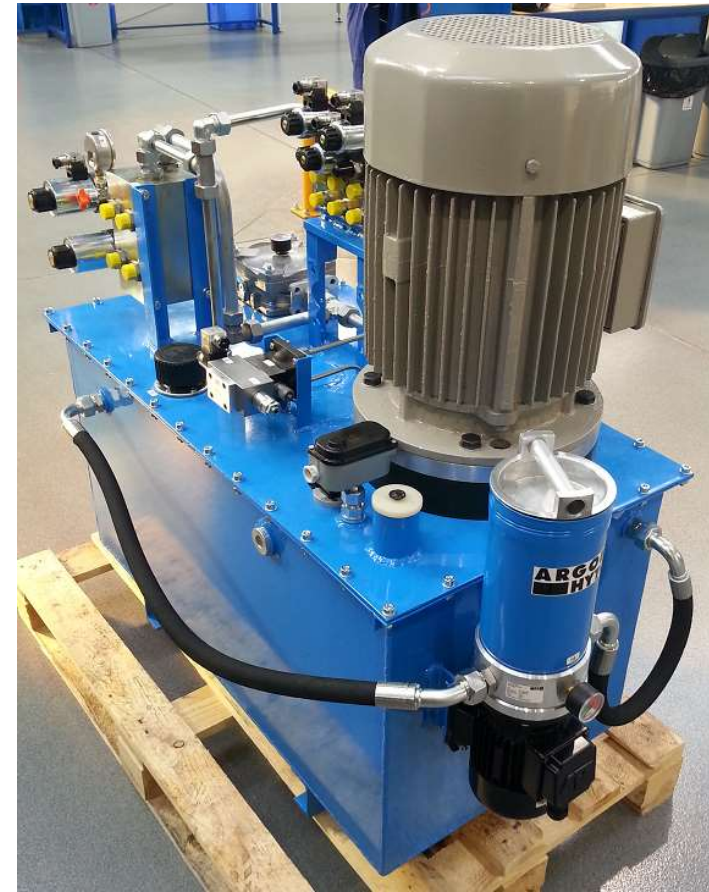
Dodatkowa filtracja boczna za pomocą agregatu FNA 008
